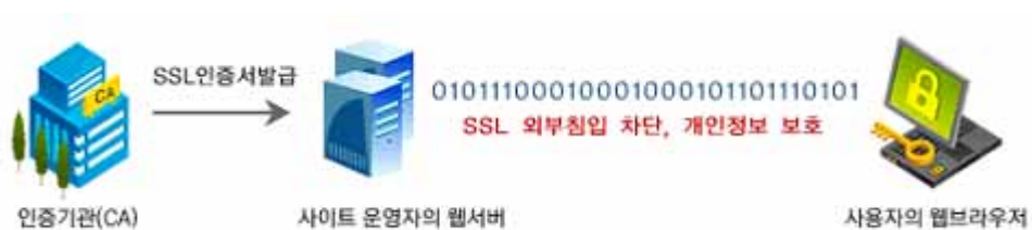
<그림 3-1> SSL 방식의 보안서버 개념도
